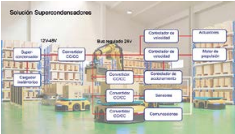
Figura 5. Arquitectura de potencia típica de un robot que utiliza una solución de energía con supercondensadores.
