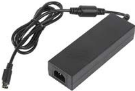
Figura 5. El AQM200PS19 es una unidad de 200 vatios de Clase I que suministra 19 voltios a un máximo de 10.6 A con una eficiencia del 92%. (Fuente de la imagen: XP Power).
