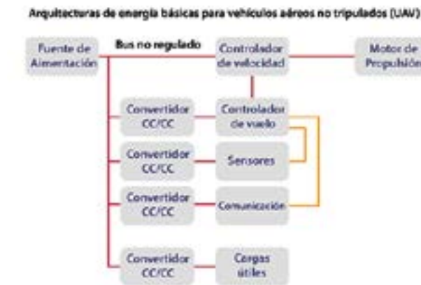
Figura 2. Arquitecturas básicas de potencia para vehículos aéreos no tripulados (UAV) - diagrama de bloques simplificado.
