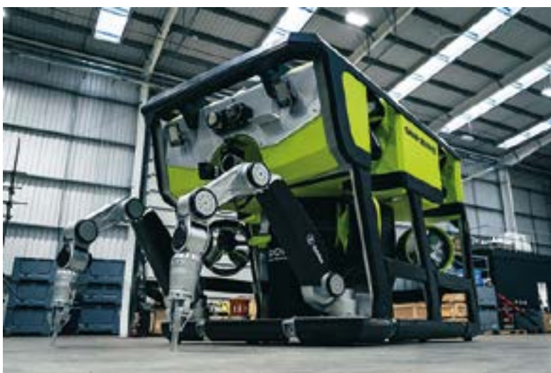
Figura 1. Saab ha desarrollado los primeros ROV totalmente eléctricos (eWROV) en operación, que se caracterizan por su versatilidad y maniobrabilidad. A diferencia de los tradicionales ROV hidráulicos, el sistema totalmente eléctrico del eWROV acaba con la necesidad de fluido hidráulico, por lo que reduce los riesgos medioambientales.
