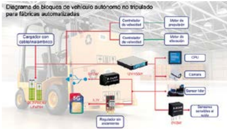
La figura 3 muestra el diagrama de bloques de un vehículo autónomo no tripulado (un robot de conducción para almacenes automatizados).
