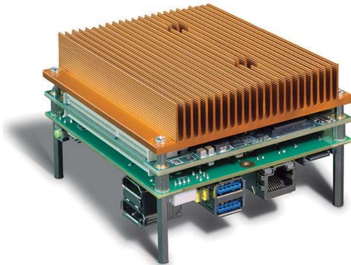
Figura 43. Rendimiento de gama alta sin ventilador, compactado en 95 x 95 mm: módulo conga-TC170 con refrigeración pasiva (tipo radiador) y placa de soporte.
