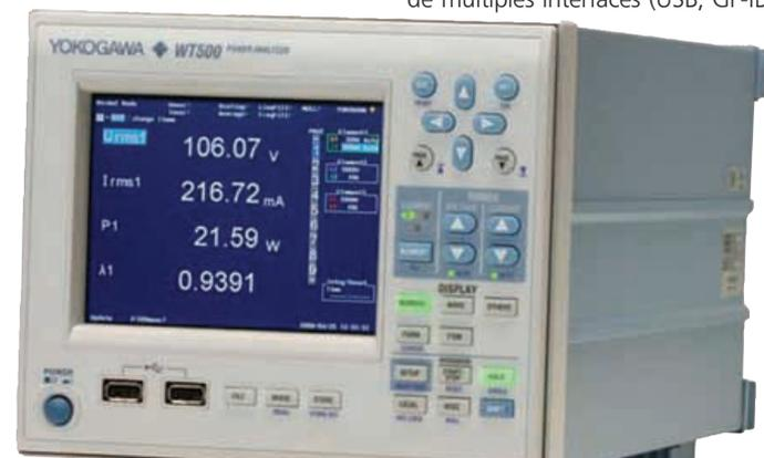
El nuevo WT500 de YOKOGAWA es un analizador de potencia compacto que puede efectuar medidas de 1, 2 ó 3 fases con tensiones de hasta 1000 V e intensidades de hasta 40 A.
