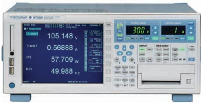
cos (también requeridas por la IEC 61000-4-7 Ed2), con una velocidad de muestreo controlada por un PLL, multiplicando la frecuencia de entrada por 900 (para 50 Hz) ó 750 (para 60 Hz).
