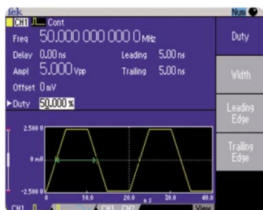
Figura 1. Pulso visualizado en la pantalla de un AFG3252.
