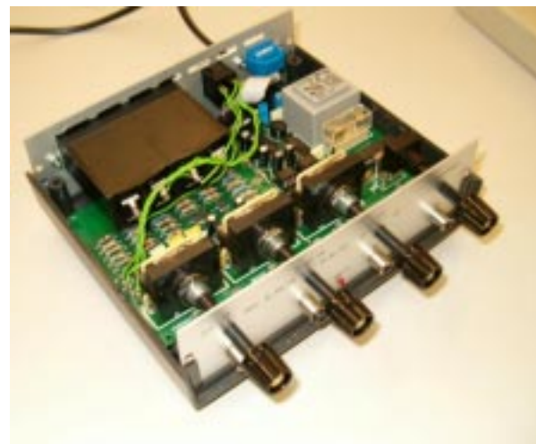
Figura 5.- Fotografía del nuevo prototipo ECG didáctico en las últimas fases de puesta a punto.
